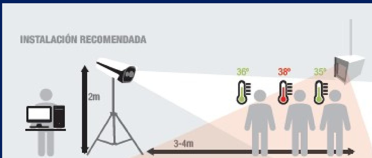
La solución Panda al igual que el modelo anterior se basa en una cámara termográfica dual IP con detección facial y medida de temperatura corporal, junto con un sistema calibrador. Por lo que el sistema de medición consigue una precisión de hasta  $\pm 0.3^{\circ}\text{C}$ . Además incorpora Reconocimiento Facial con búsqueda de caras a partir de una imagen (incluye información de temperatura).
